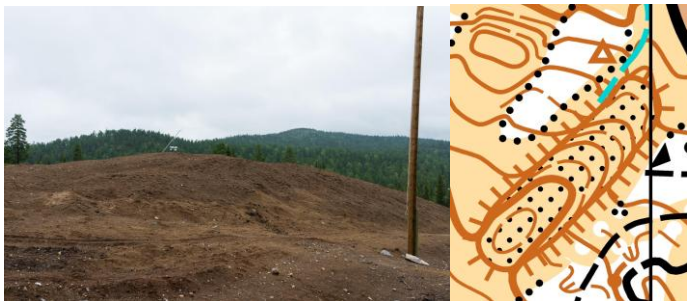
Kuva 2: sahanpurulla suojattu säilölumikasa maastossa ja kartalla.
